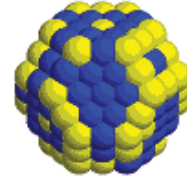
Şekil 3. Emisyon kontrolünde de kullanılan Pd-Pt alaşım katalizörlerin Monte Carlo hesaplamaları ile elde edilen atomik dizilişlerinin görüntüsü. Bu parçacık yaklaşık 2 nanometre boyutunda. Hesaplamalar Prof. Şinasi Ellialtıoğlu ile işbirliği içinde gerçekleşti (Ebru Erinal, Yüksek Lisans Tezi, 2006).
